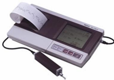
FIGUUR 14: MITUTOYO SURFTTEST SJ-301 RUWHEIDSMETER
